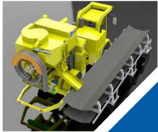
Самоходная вакуумная машина предназначена для сбора просыпей и пыли ангидрита в конвейерной штольне, в том числе под нижней веткой конвейера. Конвейер установлен под углом 8°. Машина оборудована задней пылесборной насадкой и передним манипулятором. Задняя насадка используется для сбора просыпей с дорожного покрытия в движении.
